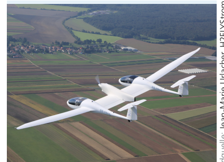
Abbildung 5: Das viersitzige Forschungsflugzeug HY4 ist das weltweit erste Passagierflugzeug, das allein mit einem Wasserstoffbrennstoffzellen-Batterie-System angetrieben wird. Die HY4 startete im September 2016 zum Erstflug vom Flughafen Stuttgart.
