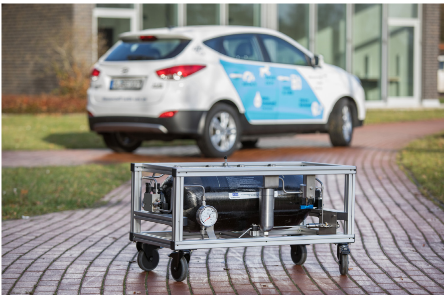
Abbildung 19: Das Betankungsmodul des DLR besteht aus einem Wasserstofftank des Typs 4 und findet Einsatz in Forschungsprojekten zur Bestimmung der Wasserstoffqualität an Tankstellen.
