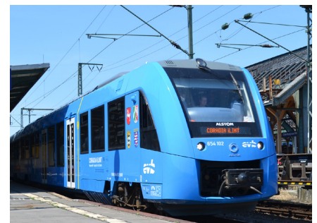
Abbildung 3: Im Rahmen der vom DLR mitorganisierten Veranstaltung „Wasserstoff treibt uns an“ ist der weltweit erste Brennstoffzellen-Triebzug „Coradia iLint“ im Juni 2019 in Oldenburg präsentiert worden. Bereits seit dem Jahr 2018 wird er erfolgreich im regulären Fahrgastbetrieb im niedersächsischen Elbe-Weser-Netz eingesetzt.
